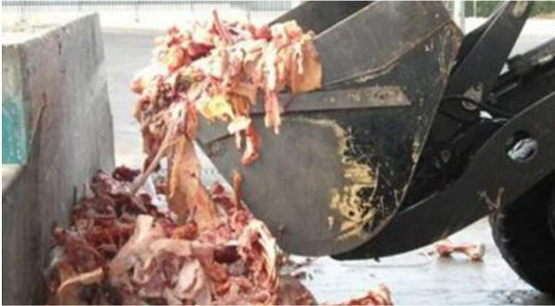
**danneggiamento dei resti**. Passo successivo è la lavorazione mediante un tritatore per ottenere un composto omogeneo che verrà destinato a impianti di essiccazione che attraverso altissime temperature (con un processo simile ad grosso "bollitore") separano la parte umida, ottenendo una "**farina animale**".
